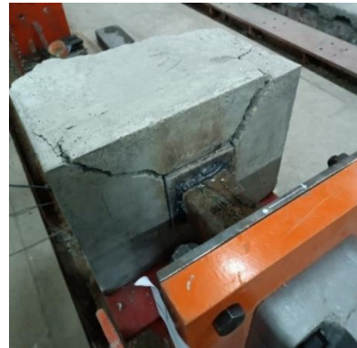
شکل ۵- ترک خوردگی و نمودار بار-جابجایی نمونه U2
