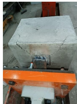
شکل ۴- ترک‌خوردگی و نمودار بار-جاب‌جایی نمونه U1
