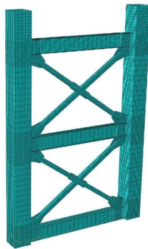
شکل (۱۶): نمای کلی از قاب تحلیل شده در نرم افزار آباکوس
