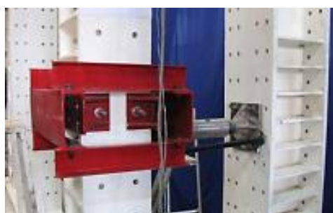
شکل ۲۵- جزئیات مهارجانبی نمونه قاب جزء (نمونه دوم)
