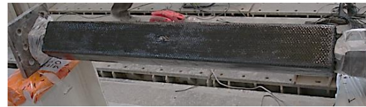
شکل ۱۱- اجرای پوشش الیاف پلیمری کربن بر روی نمونه کمانش‌تاب با غلاف بتنی
